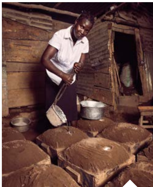
Una empresaria vierte metal fundido en moldes cubiertos de tierra para fabricar entre 120 y 230 cacerolas al día. Kampala (Uganda).
