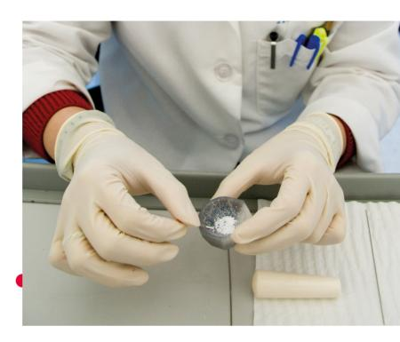
Un químico se prepara para determinar el punto de fusión de compuestos químicos en muestras de medicamentos con objeto de identificar dichos compuestos.
